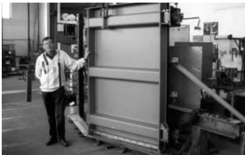
Seeseitiges Schleusentor (Bild 2)
